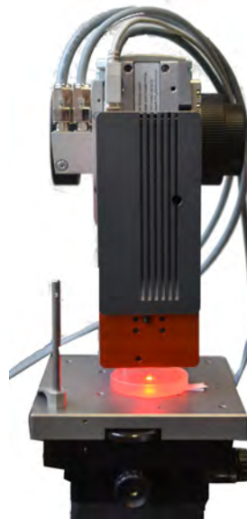
(b) System 2 mit Linearachse und wechselbarem Objektiv.
