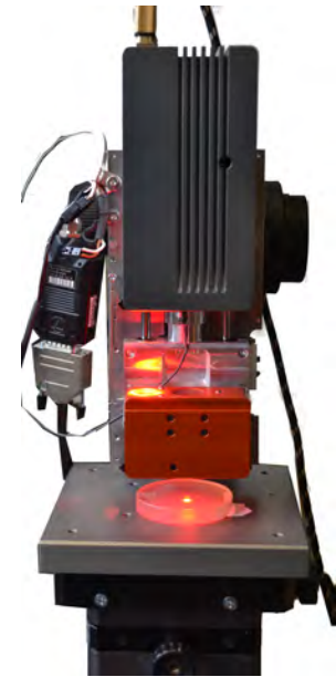
(c) System 3 mit Tauchspulenmotor und wechselbarem Objektiv.
