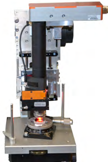
Abb. 4.17.: Veränderter Aufbau von System 1 mit Drehtisch.
