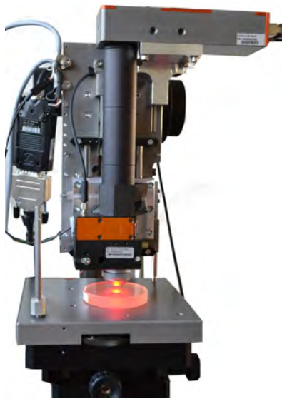
(a) System 1 mit Tauchspulenmotor und Mirau-Objektiv.
